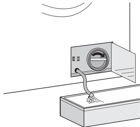
6. Когда вода перестанет литься, открутите насос и извлеките его. Всегда держите под рукой тряпку, чтобы вытереть воду, которая может пролиться при снятии насоса.
